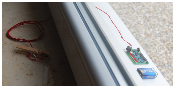
Bild 16: Fernschalter im Einsatz (auf einer nicht leitenden Fensterbank !!)
